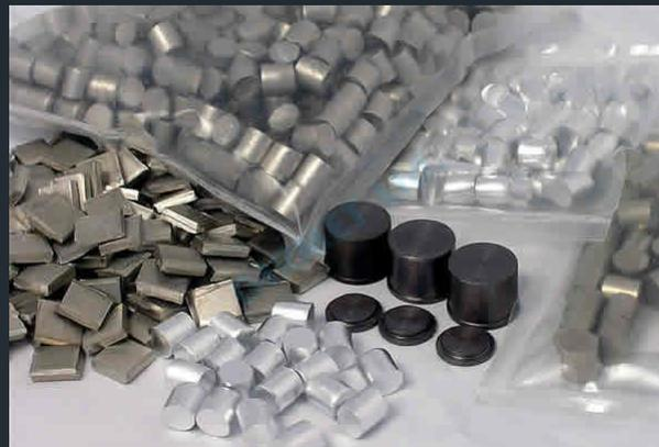
50% производимого ниобия используется для микролегирования (введение в металл небольших количеств некоторых элементов, изменяющих структуру и свойства металл) сталей, 20—30% — для получения нержавеющей и жаропрочных сплавов. Нитрид ниобия NbN используют при изготовлении мишеней передающих телевизионных трубок. Оксиды ниобия — компоненты огнеупорных материалов, керметов, стекол с высокими коэффициентами преломления.
