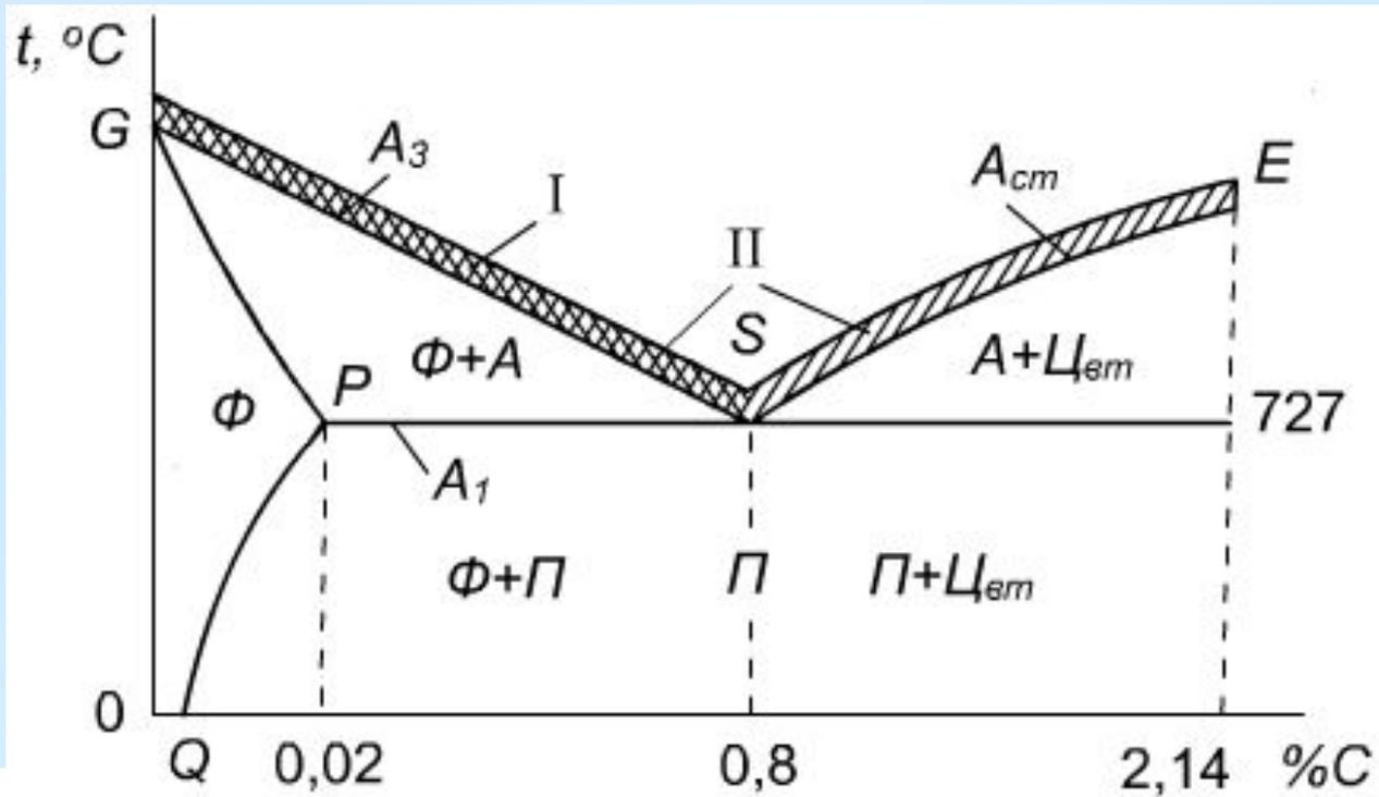
Рис. 3. Участок диаграммы Fe-Fe<sub>3</sub>C с нанесенным интервалом температур термической обработки:
