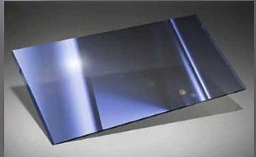
Благодаря своим магнитным свойствам аморфные металлы используются при производстве магнитных экранов, считывающих головок (аудио- и видеомагнитофонов, накопителей информации), трансформаторов и других устройств.
