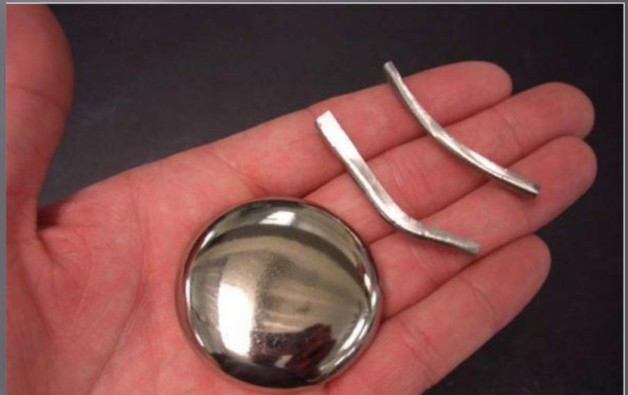
В отличие от металлов с кристаллической структурой, аморфные металлы характеризуются фазовой однородностью, их атомная структура аналогична атомной структуре переохлаждённых расплавов.
