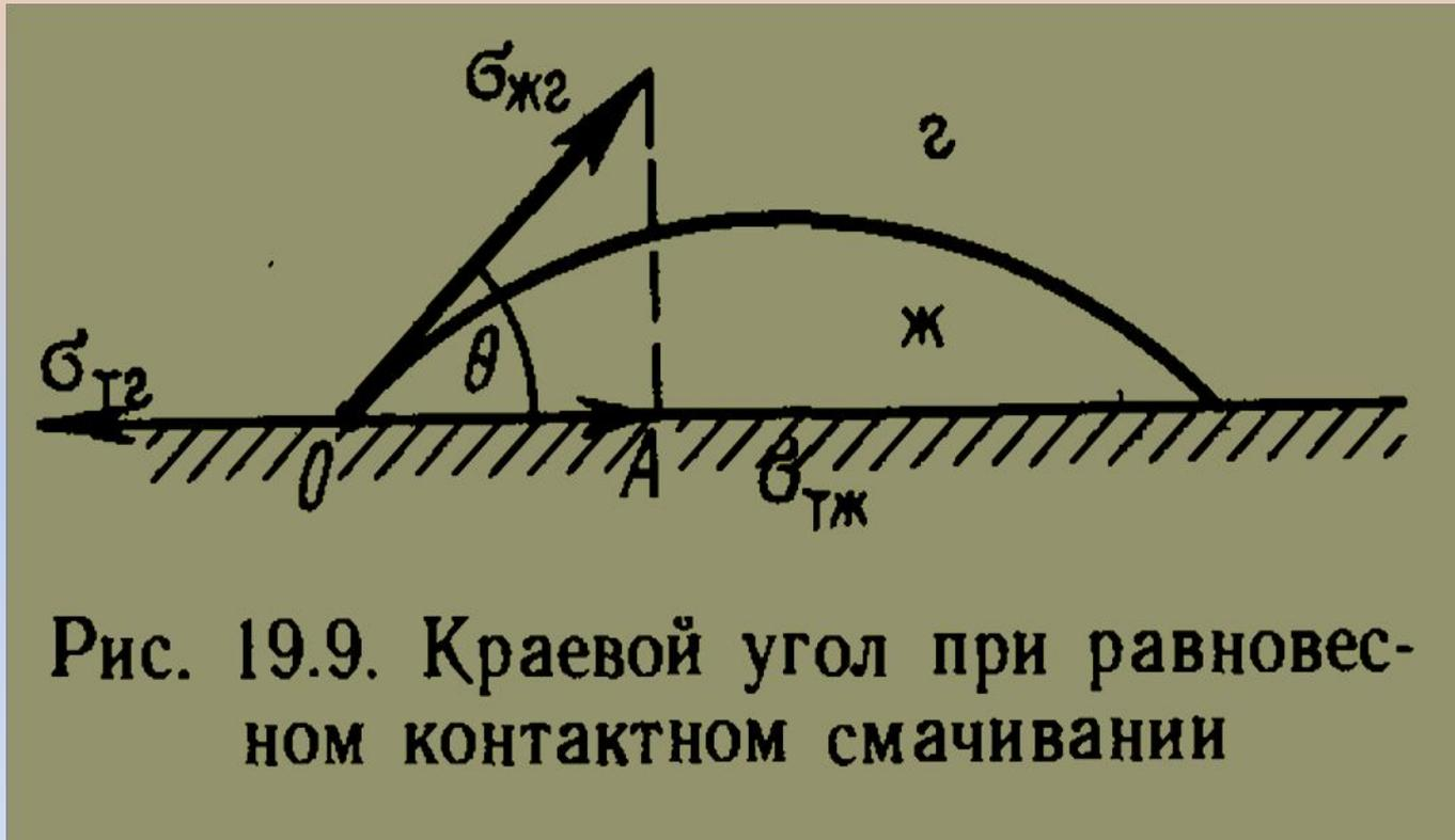
Угол между каплей и поверхностью служит количественной мерой процесса смачивания
