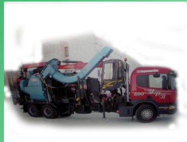
Установка рубительная передвижная УРП-600
