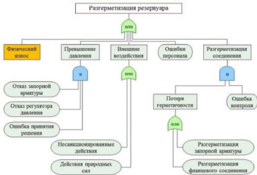
Дерево событий при возникновении аварийной ситуации «разгерметизация резервуара»
