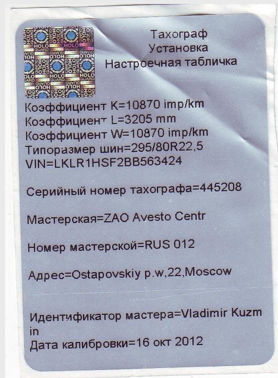
Имеется **табличка** без видимых повреждений со знаком **мастерской** о своевременно произведенной **настройке** устройства, **соответствующая данным** из **памяти** контрольного устройства и **реально установленным** типоразмерам шин.
