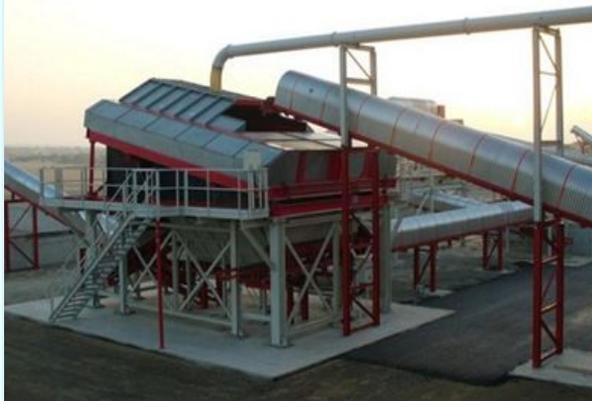
Баллистический сепаратор предназначен для разделения потока на легкие и тяжелые фракции.
