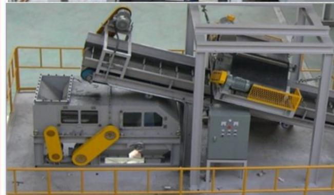
Применение магнитного сепаратора обеспечивает отбор лома черного металла и защищает оборудование от повреждения
