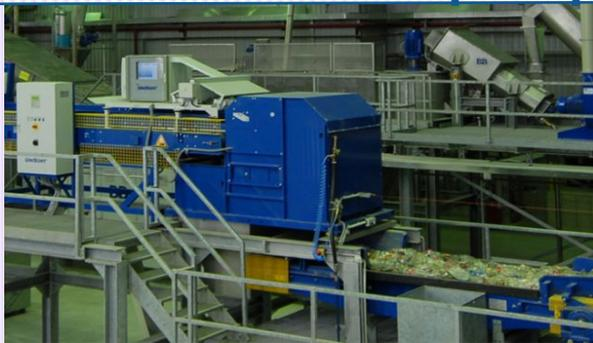
Оптический сепаратор предназначен для разделения смеси пластмасс по видам (ПП, ПЭВД, ПЭТФ - тара, ПЭ-пленки)
