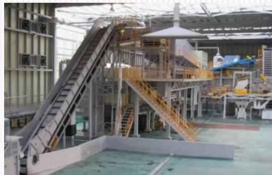
Пластинчатые конвейеры предназначены для транспортировки отходов и вторичного сырья между элементами сортировочного оборудования
