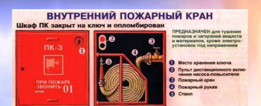
• При возникновении загорания нужно сорвать пломбу, или достать ключ (1) из места хранения на дверце шкафчика, открыть дверцу, раскатать пожарный рукав(4), после чего произвести соединение ствола, рукава и крана, если это не сделано. Затем максимальным поворотом вентиля (3) крана пустить воду в рукав и приступить к тушению загорания.
