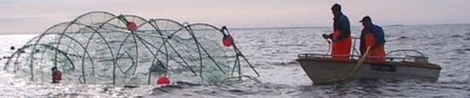
**Принцип действия:** при откачивании воздуха из понтонной основы рабочая часть вентерья опускается на дно, а при накачивании воздухом – всплывает на поверхность.
