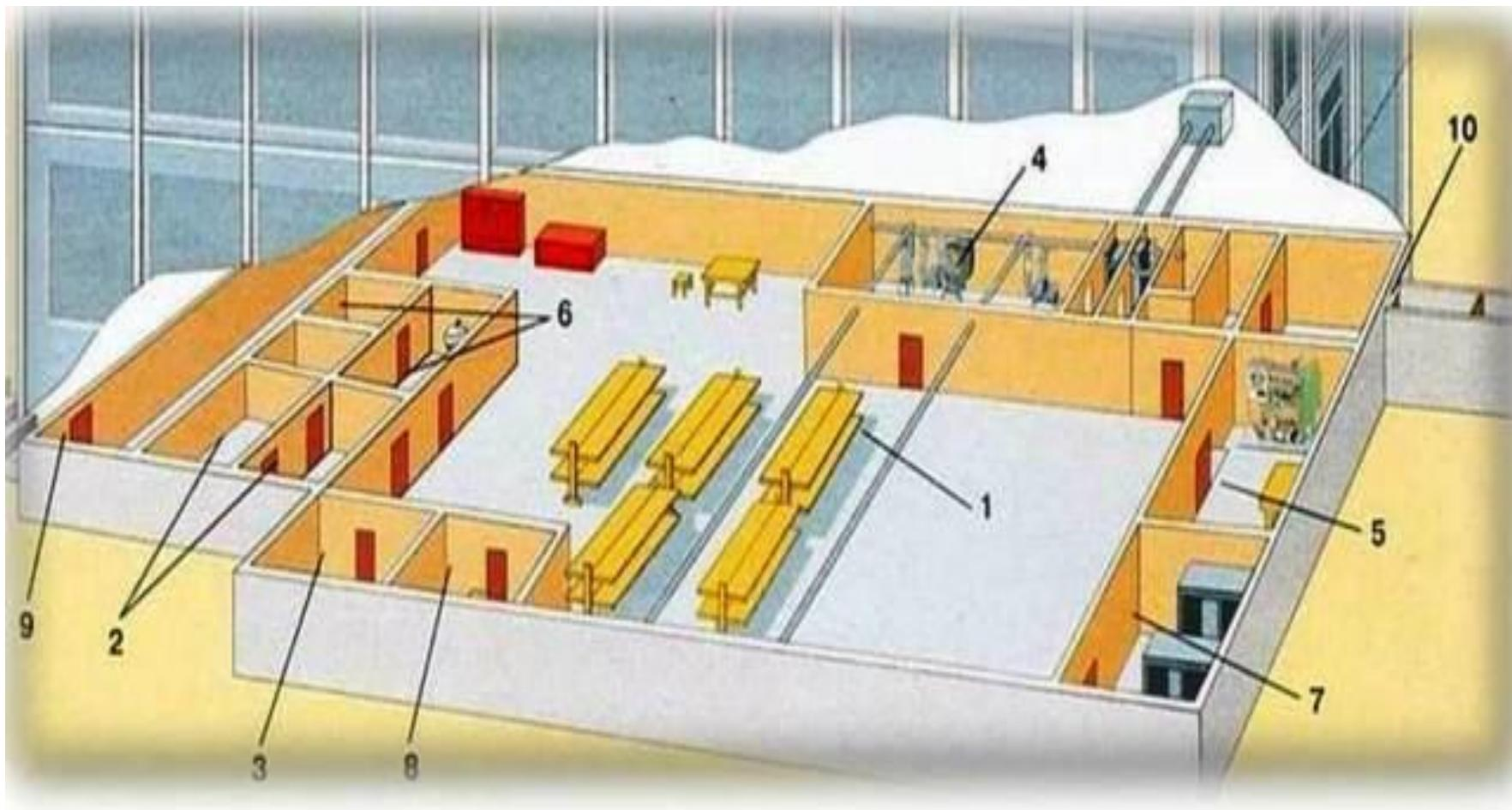
План убежища: 1— помещение для укрываемых; 2— пункт управления; 3— медицинский пункт (может не устраиваться); 4— фильтровентиляционная камера; 5— помещение дизельной электростанции; 6— санитарный узел; 7— помещение для ГСМ и электрощитовая; 8— помещение для продовольствия (может не устраиваться); 9— вход с тамбуром; 10— аварийный выход с тамбуром.
