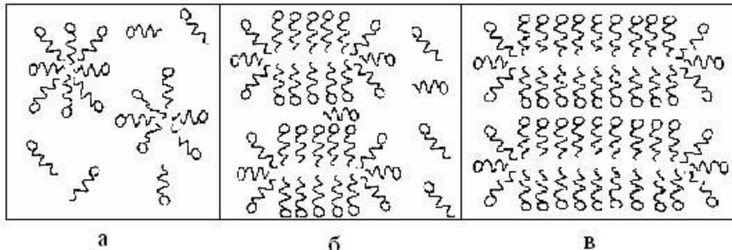
Рис. 5.5. Схема образования мицелл: а – раствор, содержащий сферические мицеллы; б, в - концентрированные растворы, содержащие пластинчатые мицеллы
