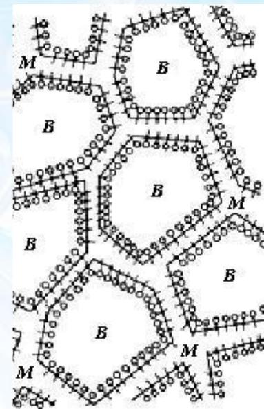
Строение высококонцентрированной эмульсии В/М.
