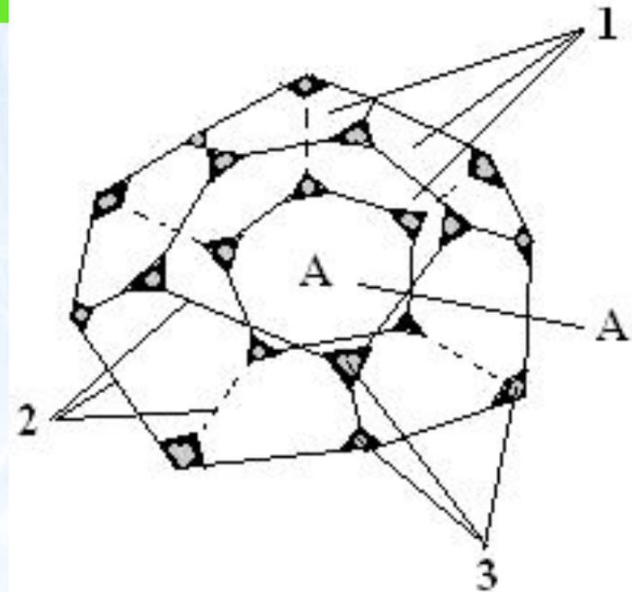
1-пленка жидкости, 2-каналы, 3-узлы
