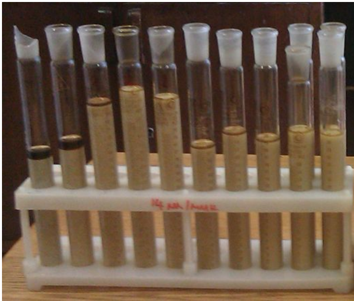
Рис. 4. Полученные эмульсии после разделения и после отстаивания в течение 24 часов
