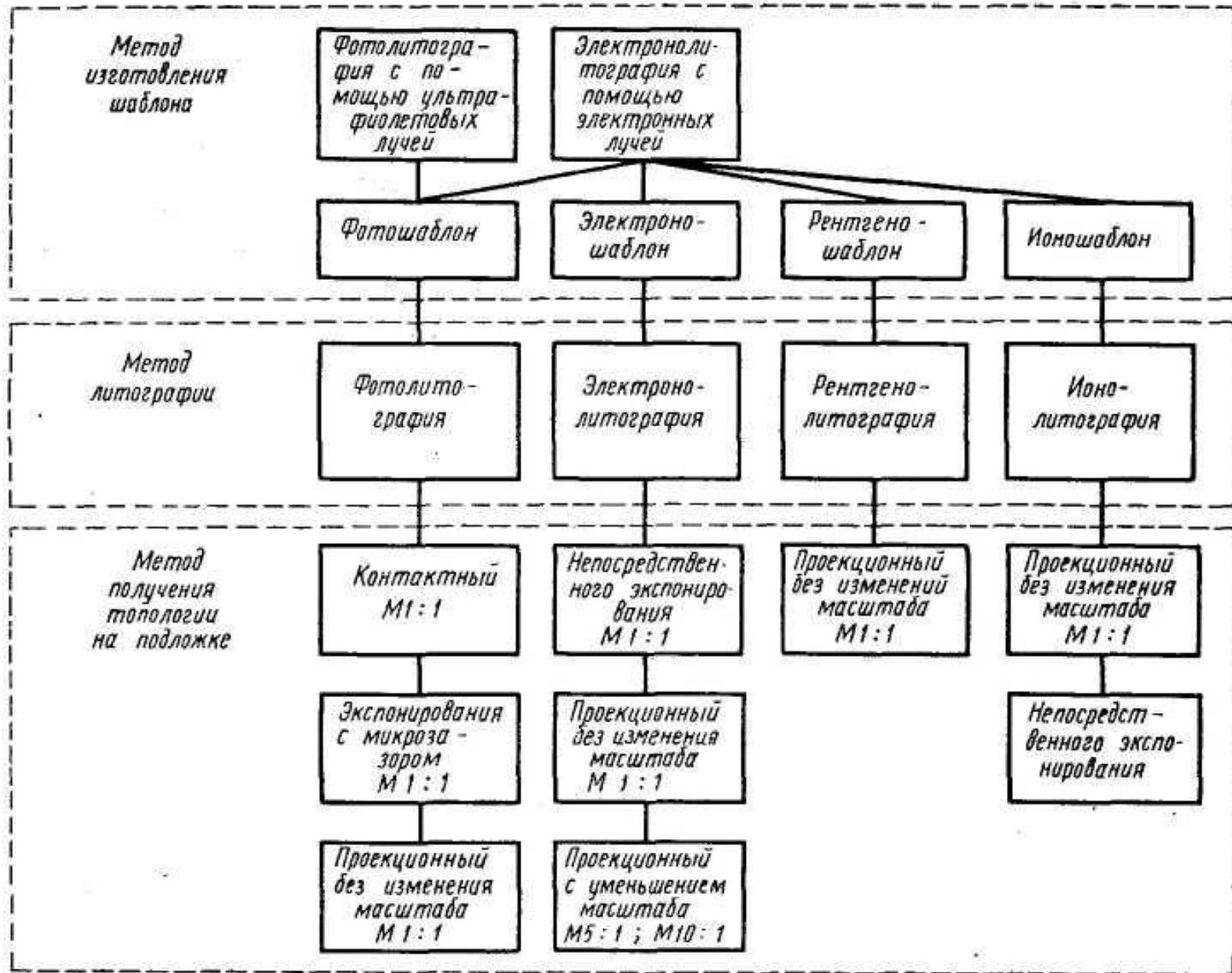
Фотолитография — это сложный технологический процесс, основанный на использовании необратимых фотохимических явлений, происходящих в нанесенном на подложки слое фоторезиста при его обработке ультрафиолетовым излучением через маску (фотошаблон).
