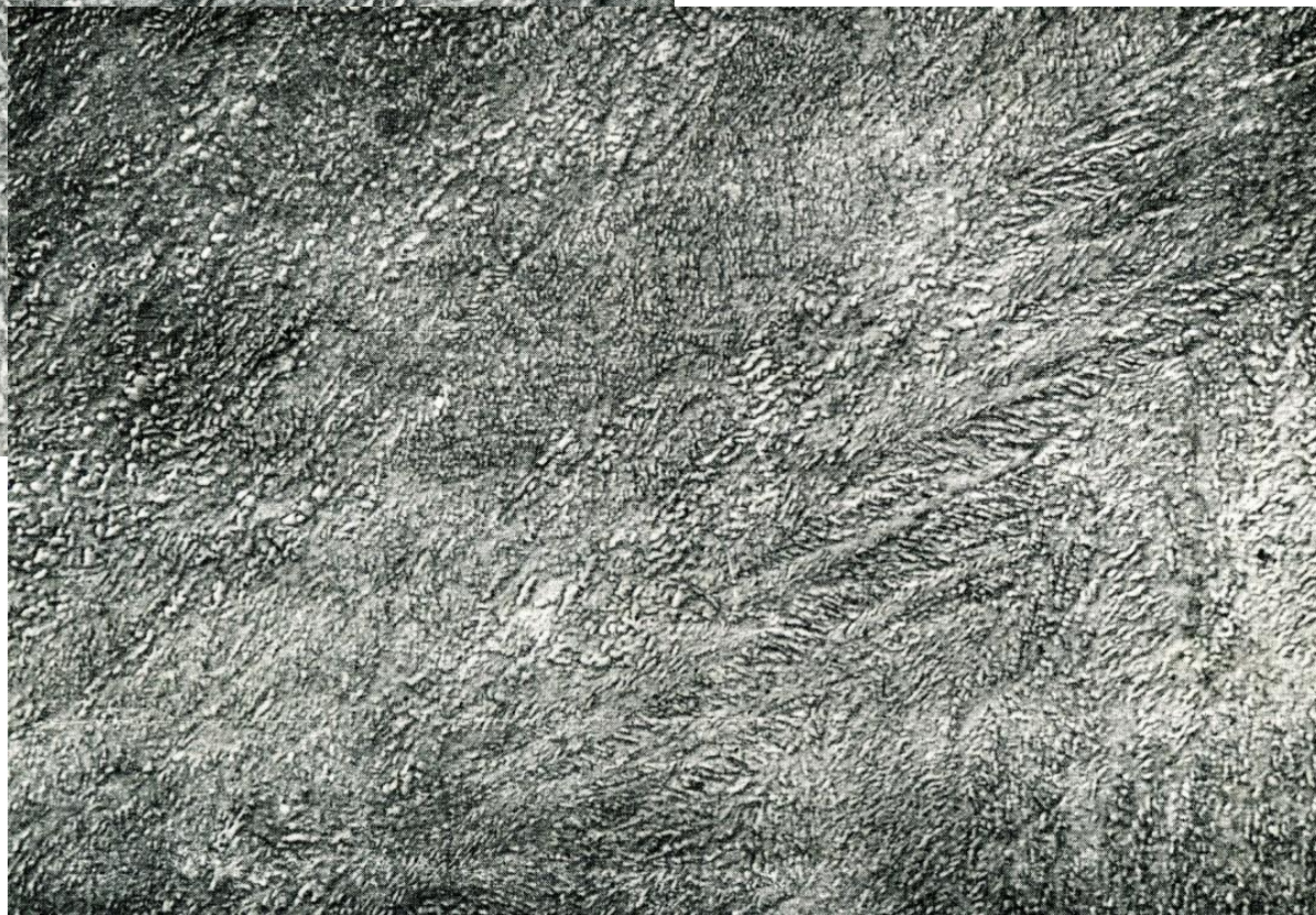
Электронные микроструктуры бейнита (x15000): а) верхнего, б) нижнего
