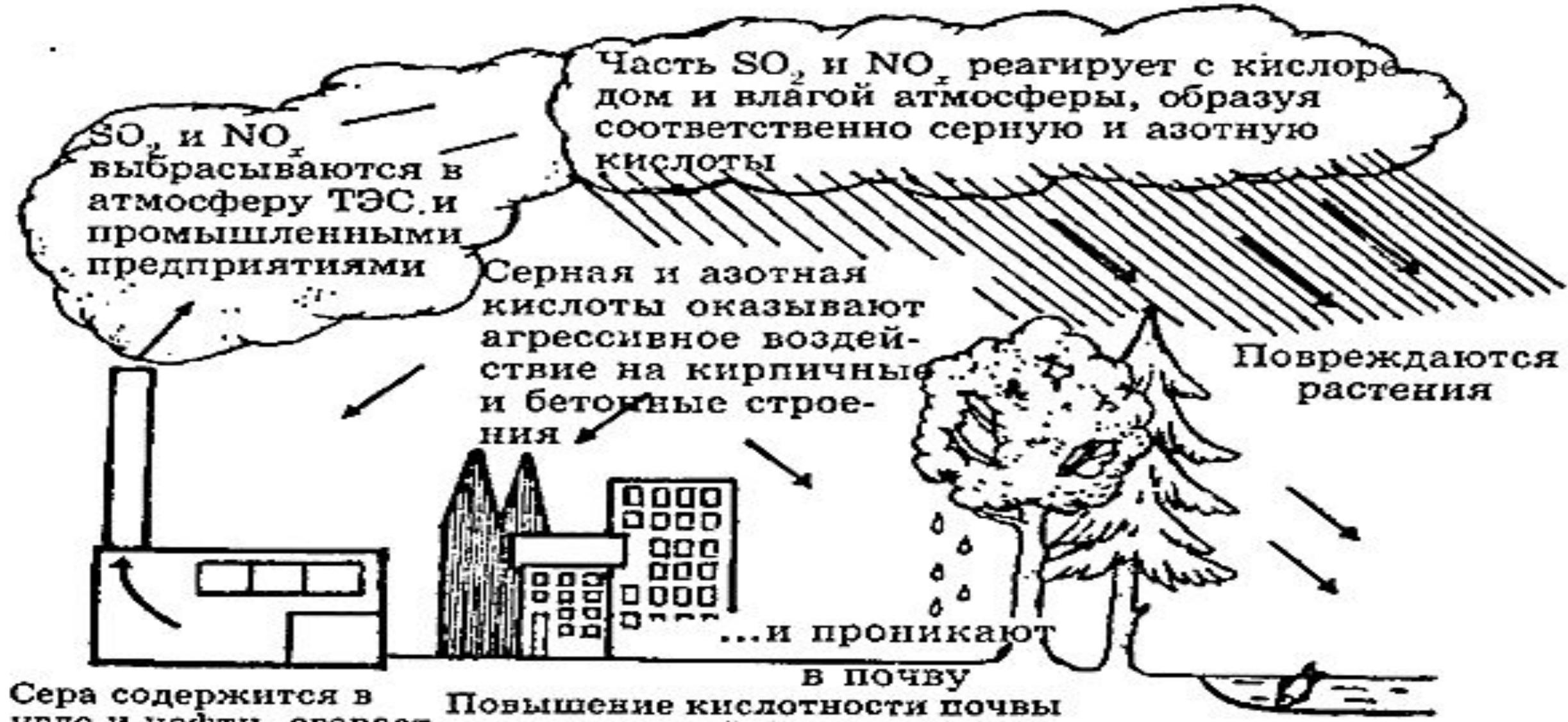
Сера содержится в угле и нефти, сгорает с образованием  $\text{SO}_2$
