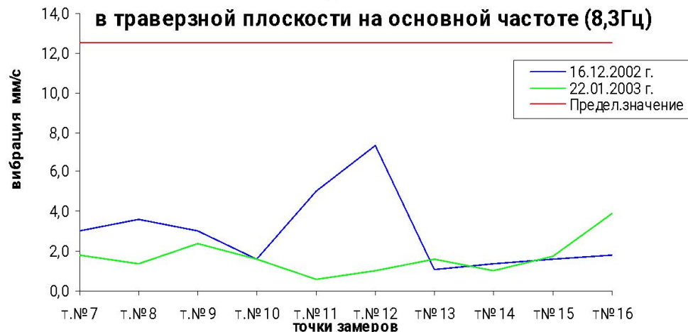
График изменения значений виброскорости по точкам замеров ВДГ№2 в районе рамовых подшипников
