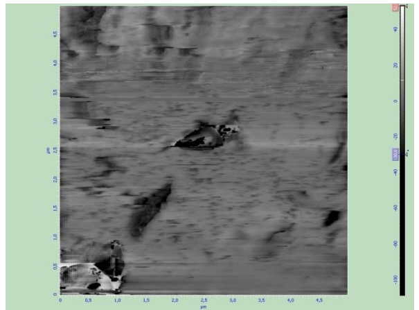
Пленка Инновационной присадки на поверхности стекла (атомно-силовая микроскопия)
