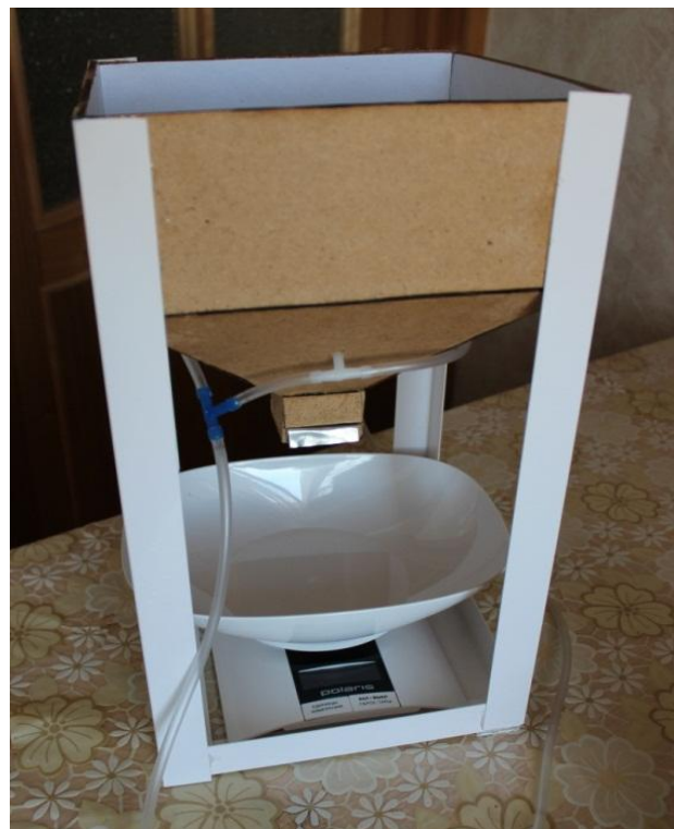
1 - бункер; 2 - герметичная камера; 3 - стойки; 4- емкость; 5 - аналитические весы; 6 – планка; 7 – магнит. Рисунок 5 – Схема экспериментальной установки.
