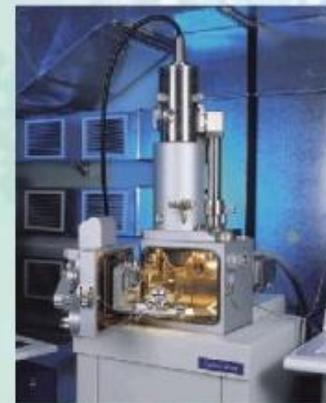
Сканирующий электронный микроскоп.
