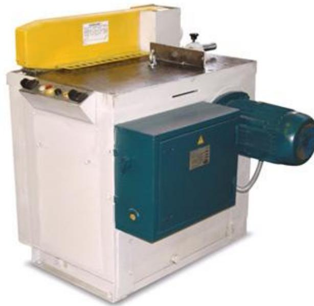
Рисунок 4 – Станок торцовочный ЦКБ 40.01. Двуручное управление
