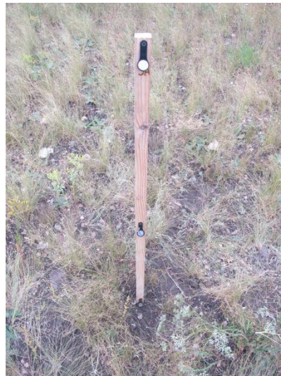
Установка дополнительных снегомерных реек и мобильных регистраторов температуры и влажности на стационарных мониторинговых участках («Буртинская степь», июль 2015г.)
