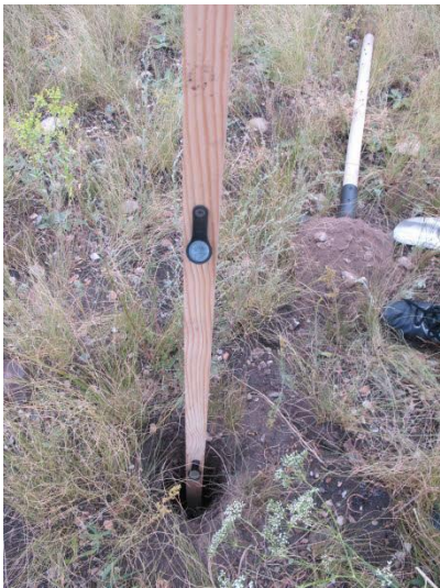
Установка дополнительных снегомерных реек и мобильных регистраторов температуры и влажности на стационарных мониторинговых участках («Буртинская степь», июль 2015г.)
