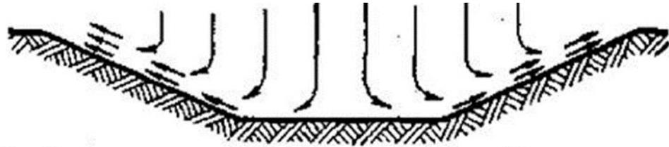
Рис. Движение воздуха в карьере при конвективной схеме проветривания
