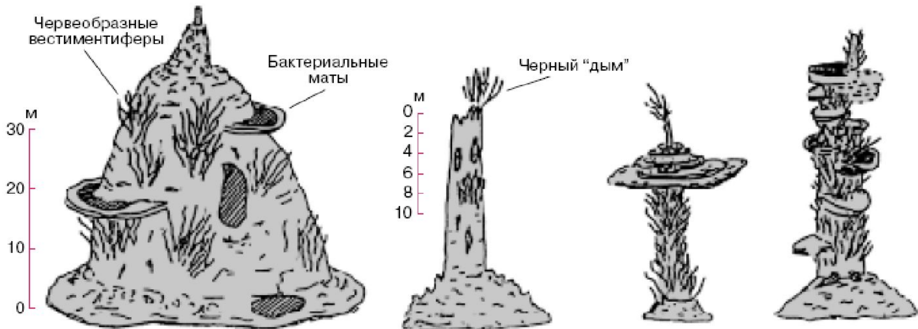
Рис. 1. Морфология высокотемпературных гидротермальных сульфидных построек [2]
