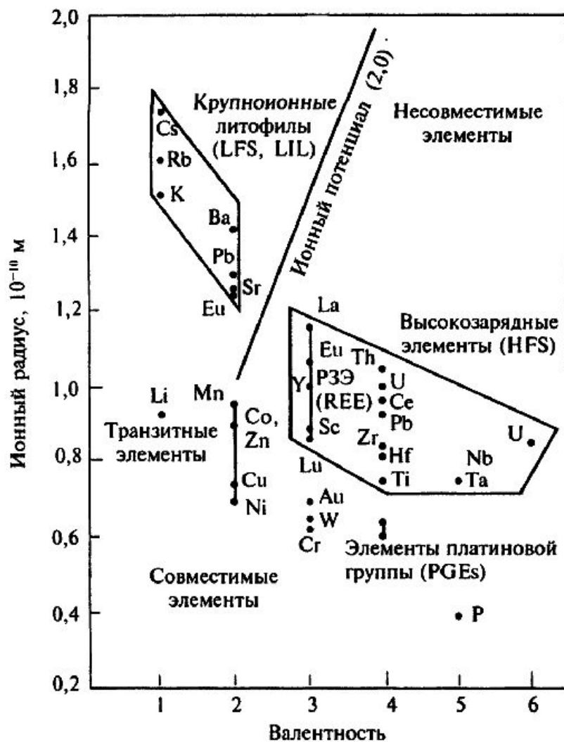
Рис. 1.2. Диаграмма ионный радиус — ионный заряд для элементов-примесей: ионный потенциал (отношение заряда к радиусу), равный 2, разделяет поля крупноионных литофилов и высокозарядных элементов
