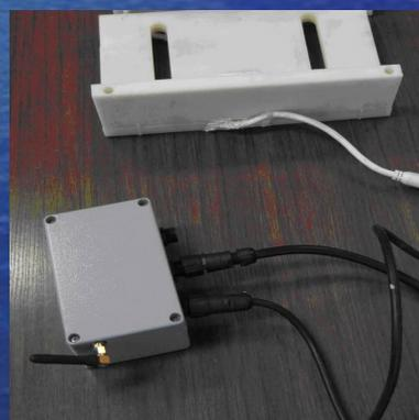
Бортовой модуль - передатчик
