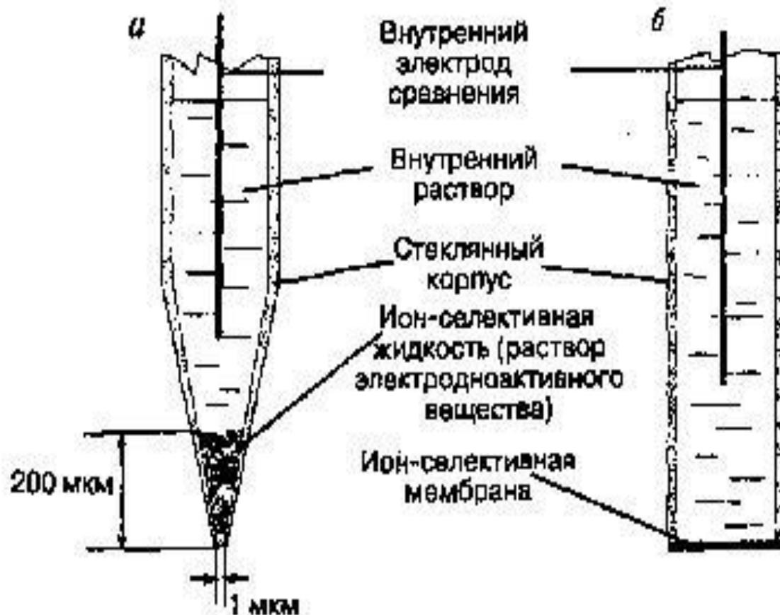
Рис.3. Ион-селективные электроды: а – микроэлектрод; б – мембранный макроэлектрод
