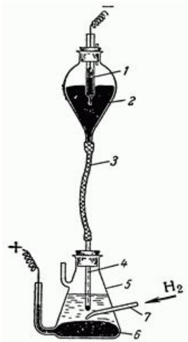
Рис. 3. Схема простейшего капельного ртутного катода:
