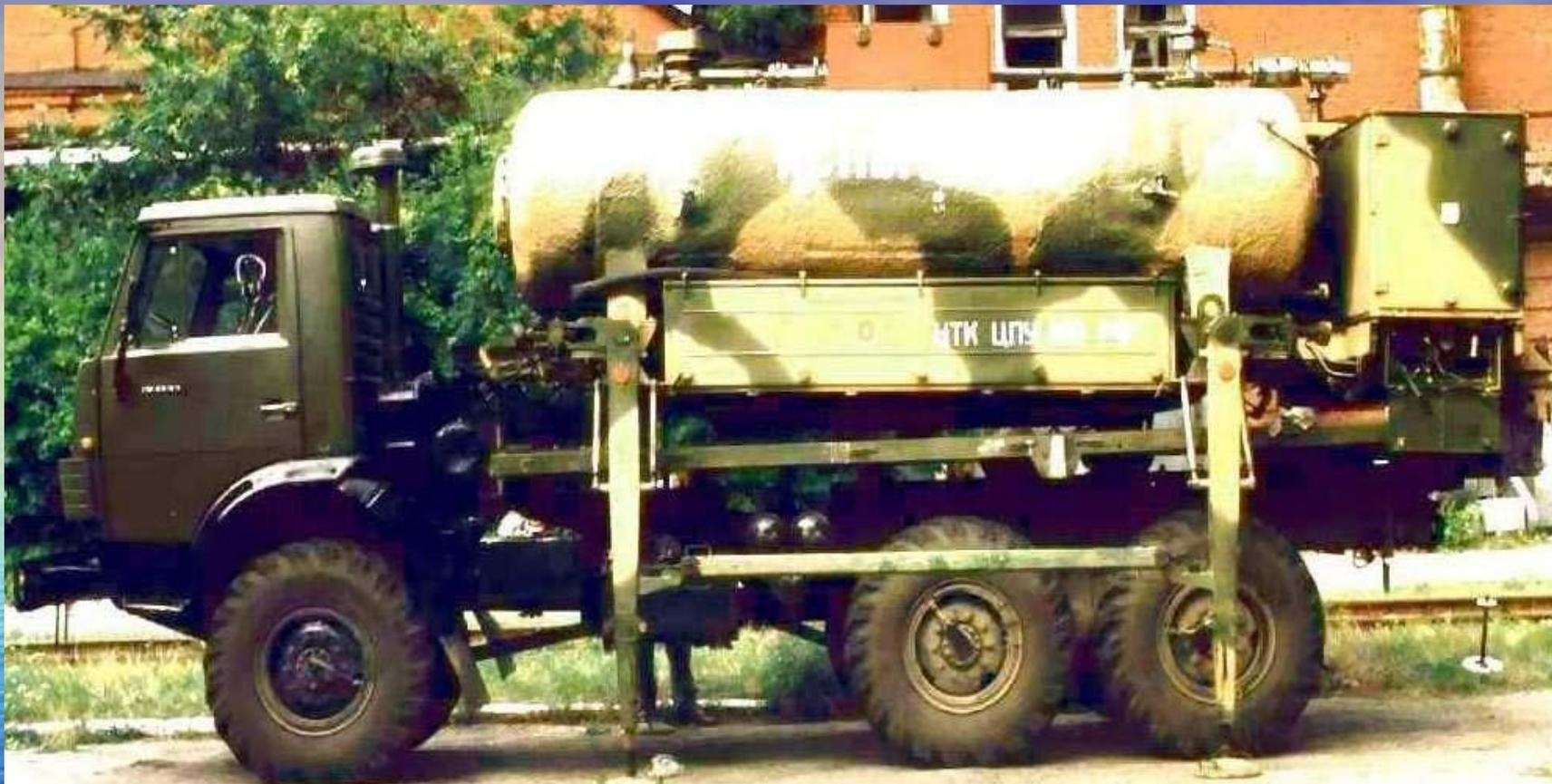
**Мобильная войсковая система очистки и обеззараживания природных вод СООПВ-2 в составе модуль цистерны МЦПТ-5,5 по заказу Мин.обороны РФ. Войсковые испытания, показали полное соответствие требованиям ТТЗ. Система обеспечивает очистку и обеззараживание вод природных источников до уровня требований СанПин 2.1.4.559-96 «Питьевая вода» при **очень высокой исходной бактериальной загрязненности (коли-индекс более 1100).****
