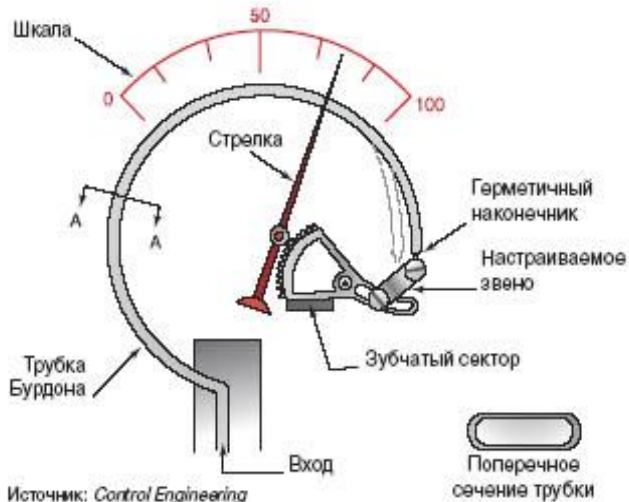
Традиционная конструкция механического манометра
