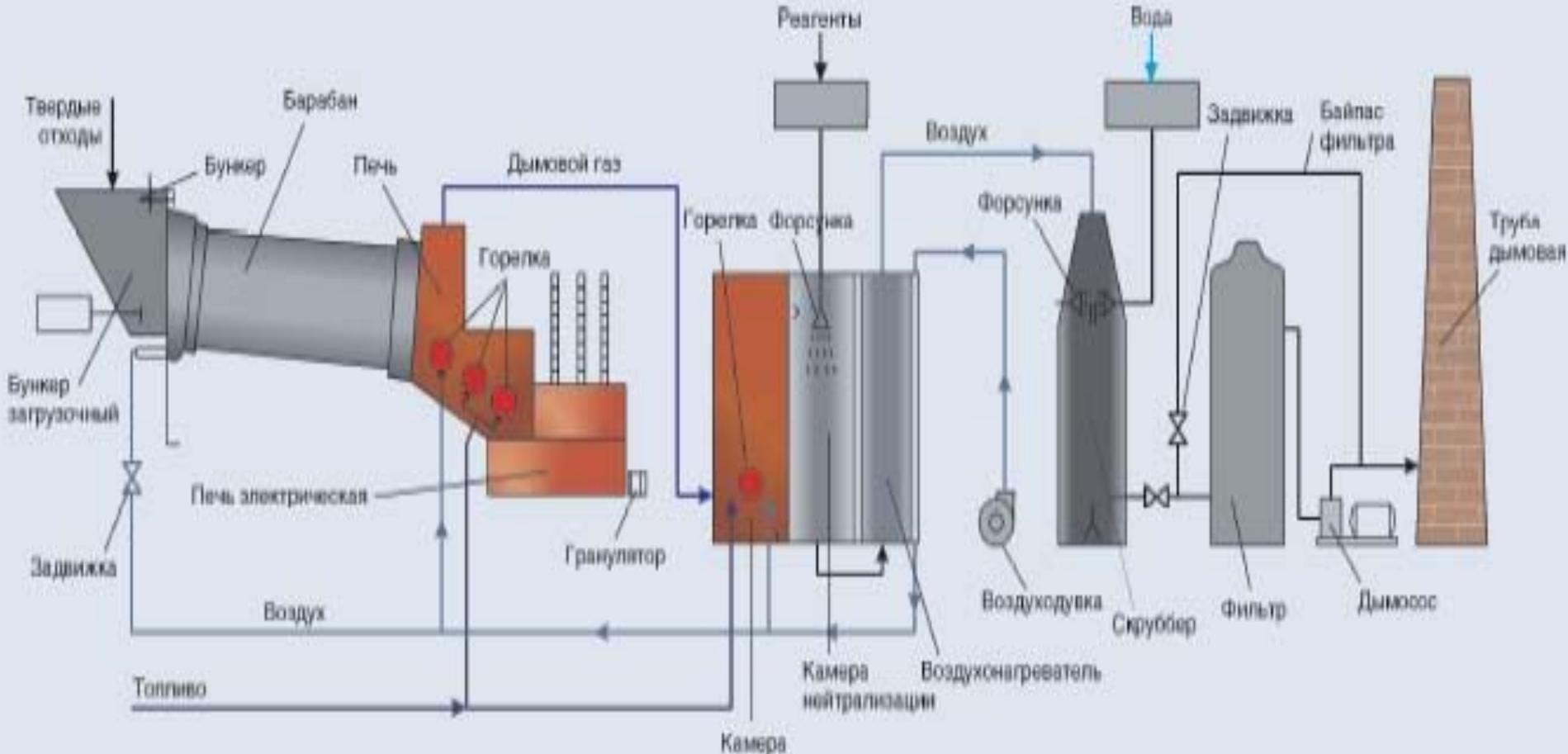
**Используется новый метод высокотемпературной переработки отходов в децентрализованных установках относительно небольшой мощности (1 – 50 тысяч тонн в год)- “Пироксэл”. Он базируется на комбинации процессов: “сушка” – “пиролиз” – “сжигание” – “электрошлаковая обработка” – “химико-термическое обезвреживание газов”.**
