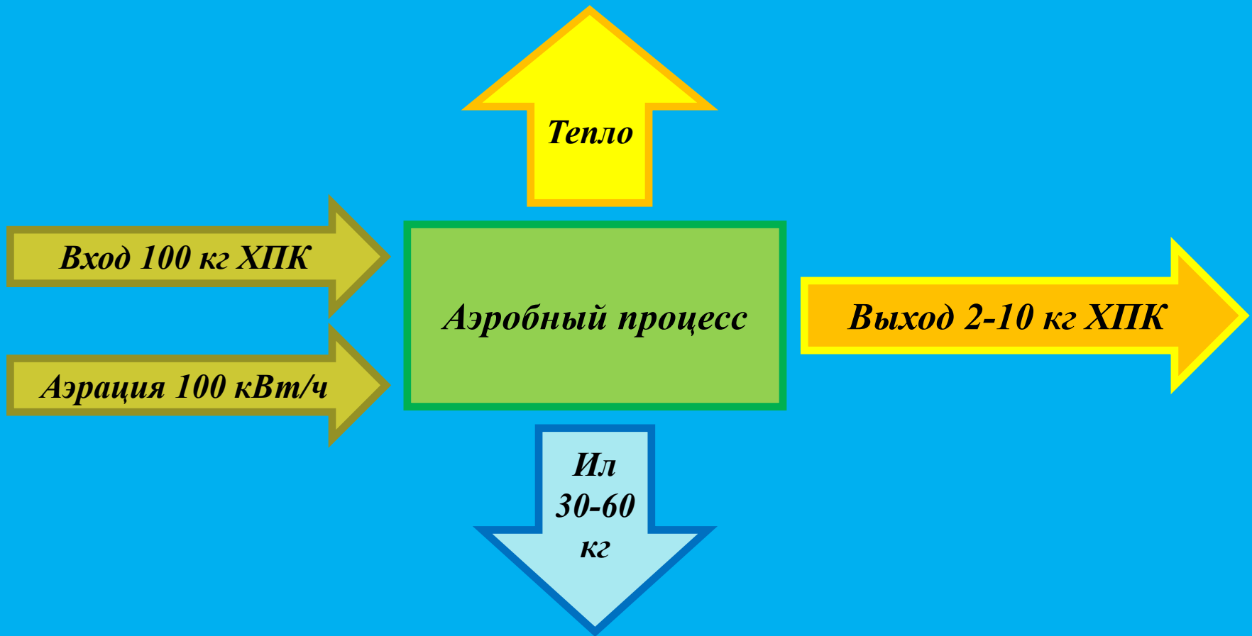
Рис.4 Аэробная очистка сточных вод
