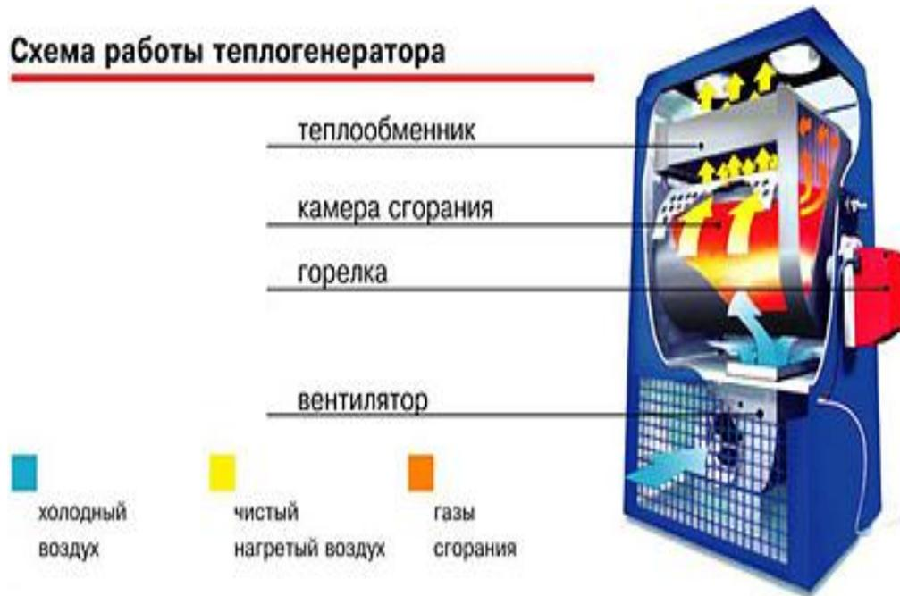
Типовая конструкция теплогенератора: вентилятор (осевой или центробежный), над ним камера сгорания, в ее нижнюю часть введена горелка, над горелкой расположен воздушный теплообменник.
