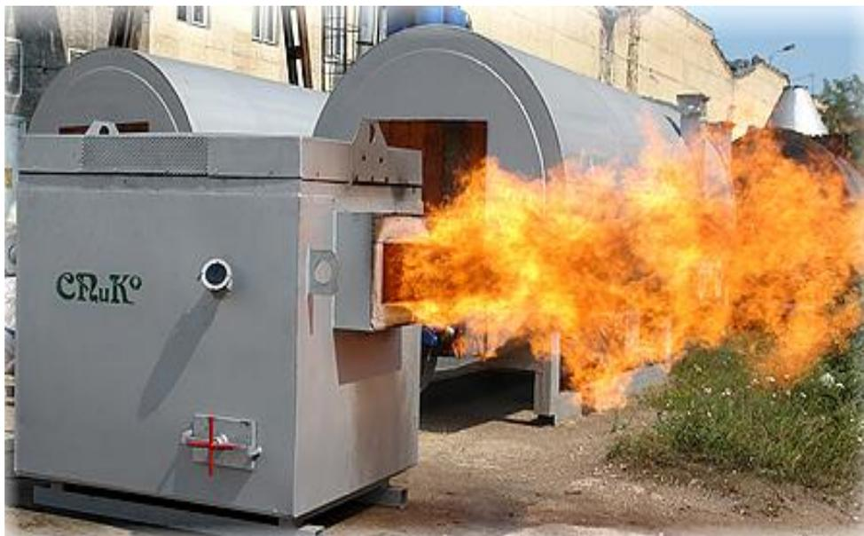
Оснащены вентилятором, прогоняющим воздух через теплообменник и подающим его к отапливаемым помещениям, имеют колосники и дверцу загрузки топлива. В твердотопливных теплогенераторах сжигают сухое дерево, брикеты торфа, каменный уголь, различные отходы сельского хозяйства. Такие теплогенераторы имеют КПД порядка 80–85 %.
