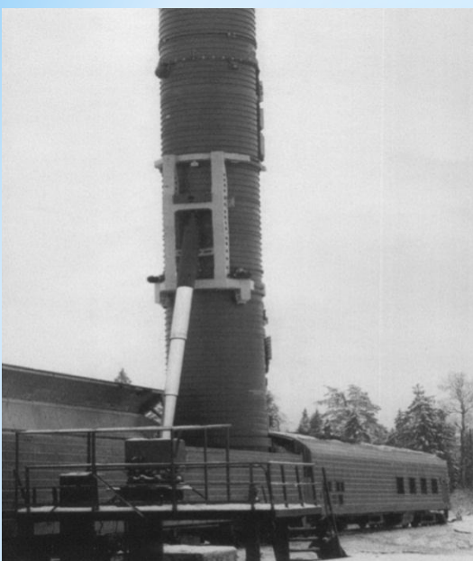
Рис. 3. МБР «Скальпель» (PS-22), в транспортно-пусковом контейнере
