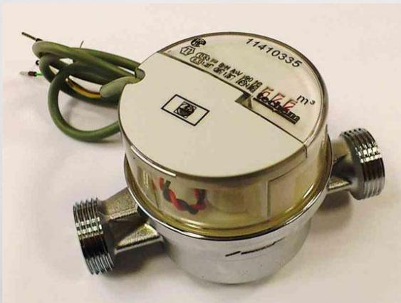
Механические счетчики тепла
