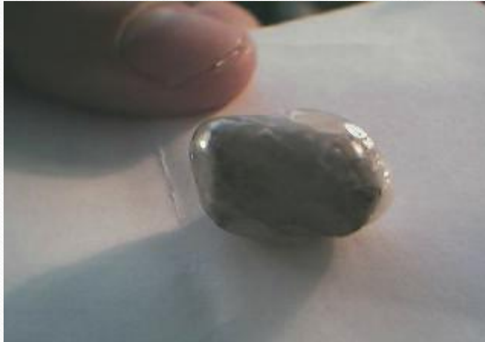
Сурет-4. Тығыздықты анықтау кезінде парафинмен қапталған үлгі.
