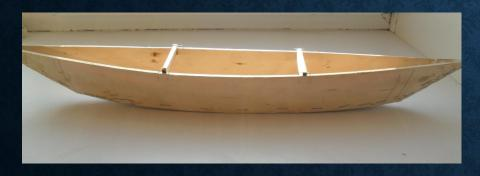
5. Сборка оморочки. Степлером соединили края бортов и дна лодки.
