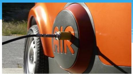
\* В настоящее время выпускаются воздухомобили (пневмомобили), так называются автомобили, имеющие пневматический двигатель, для работы которого используется сжатый воздух. Накопление энергии происходит посредством нагнетания его в баллоны. Затем, проходя через систему распределения, сжатый воздух попадает в пневмодвигатель, который и приводит машину в движение.
