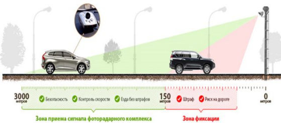
Схема работы камеры фиксации скоростного режима
