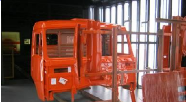
Зона осмотра каркаса кабины
