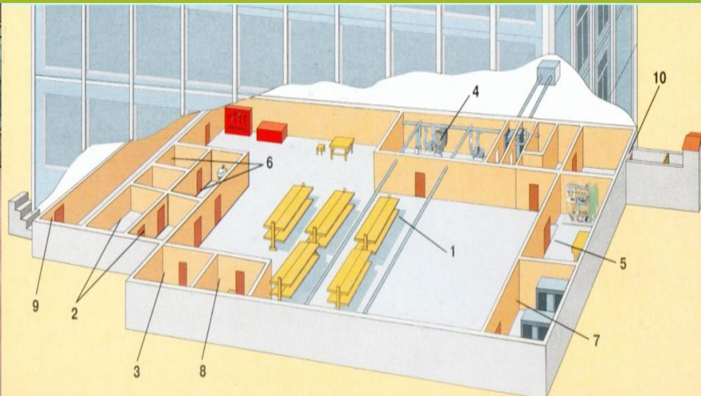
ЗАЩИТНЫЕ СООРУЖЕНИЯ В ЗАВИСИМОСТИ ОТ ИХ ЗАЩИТНЫХ СВОЙСТВ ПОДРАЗДЕЛЯЮТСЯ НА **УБЕЖИЩА (У)** И **ПРОТИВОРАДИАЦИОННЫЕ УКРЫТИЯ (ПРУ)**. КРОМЕ ТОГО, ДЛЯ ЗАЩИТЫ ЛЮДЕЙ МОГУТ ПРИМЕНЯТЬСЯ **ПРОСТЕЙШИЕ УКРЫТИЯ (ПРУК)**
