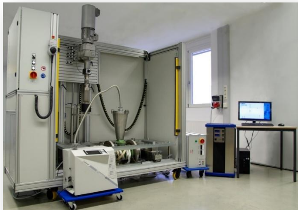
Испытательный центр для запорной и регулирующей арматуры Amtec Temes valve (DN150/PN250, DN250/PN25)
