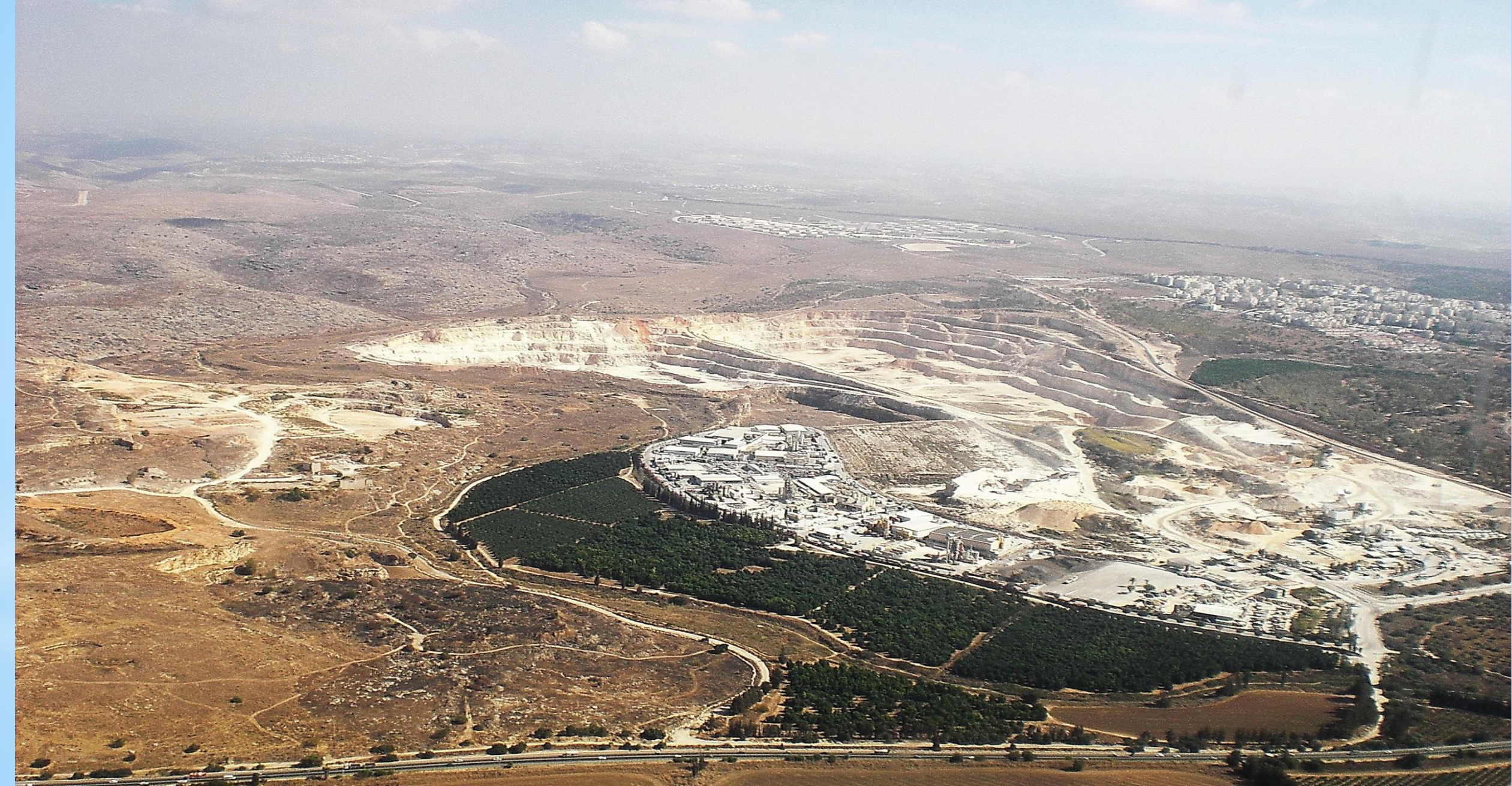
Виден карьер по заготовке мрамора и строительного камня для Иерусалима, где местное законодательство требует использования натуральных материалов для облицовки зданий.
