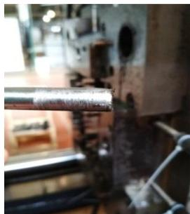
2. Между плитами формы, мы видим просачивание капелек воды. В следствии этого коррозией покрылись все толкатели, предназначенные для съёма изделий, а на некоторых появились даже раковины. В самом плохом состоянии центральный толкатель.
