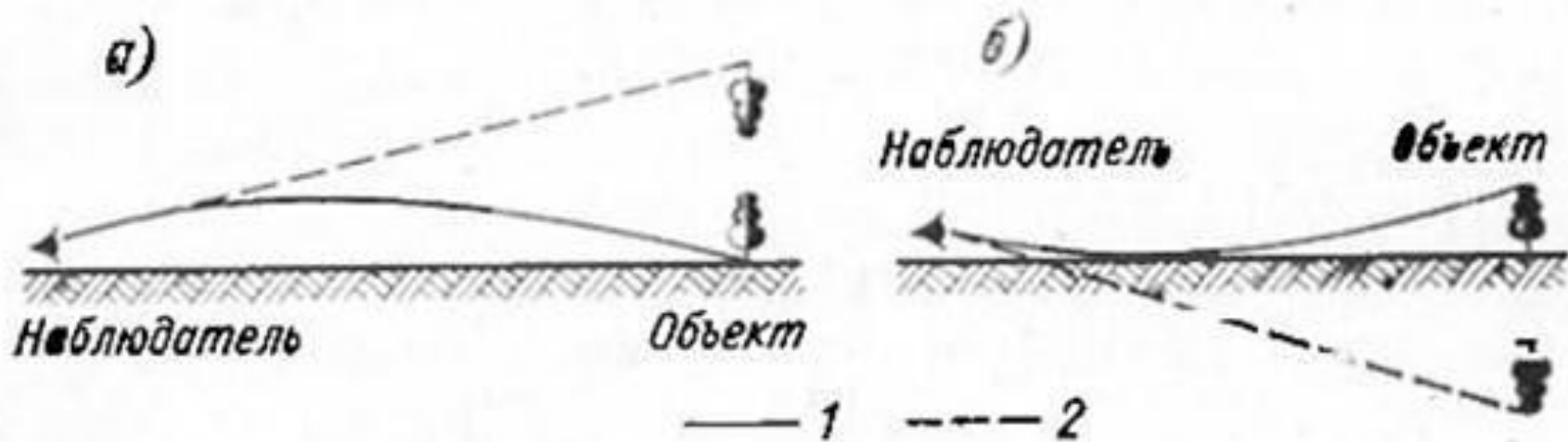
Рис. Рефракция световых лучей в слоях воздуха различной плотности.
