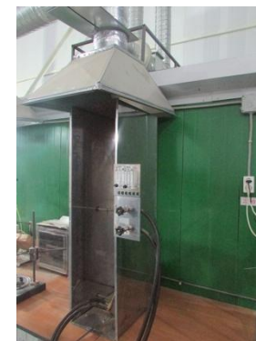
Установка экспериментального определения не распространения горения кабелей проложенных в пучках
