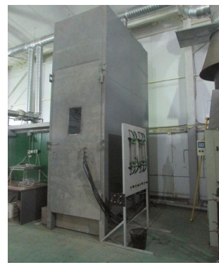
Установка экспериментального определения не распространения горения кабелей проложенных в пучках
