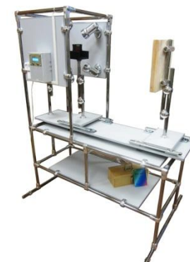
Стенд для испытаний извещателей пожарных дымовых линейных
