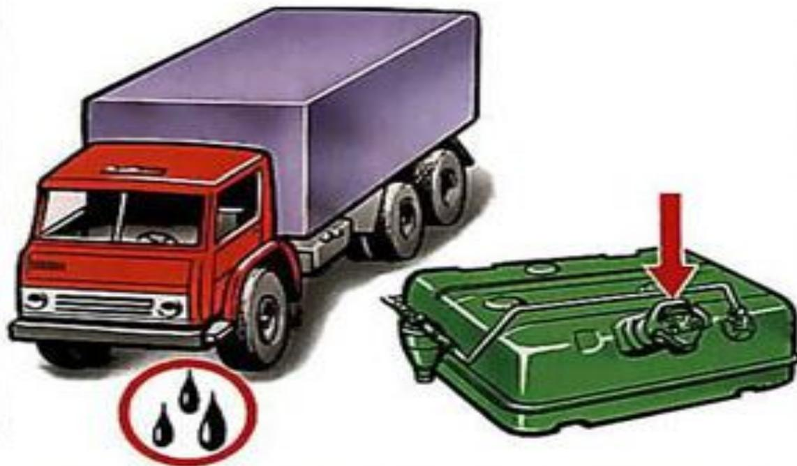
**В ПОМЕЩЕНИЯХ РЕМОНТНО – СТОЯНОЧНОГО БОКСА НЕ ДОПУСКАТЬ ПРОТЕЧКИ ГОРЮЧИХ ЖИДКОСТЕЙ НА ПОЛ. ГОРЛОВИНА У ТОПЛИВНОГО БАКА ДОЛЖНА БЫТЬ ВСЕГДА ЗАКРЫТА.**
