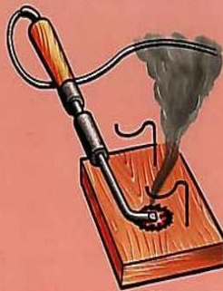
Отсутствие несгораемой подставки под электронагревательным прибором
