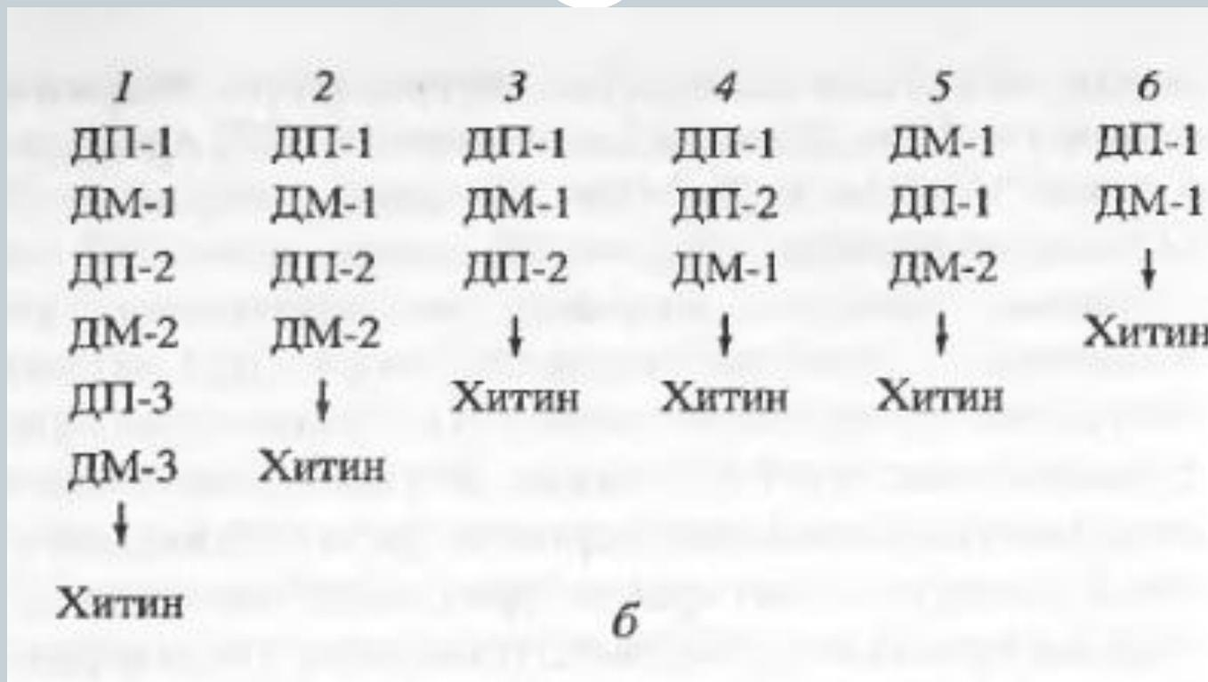
В зависимости от вида ХСС и требуемого качества хитина, а также получаемого из него хитозана количество операций ДП и ДМ, и их последовательность могут быть различными .
