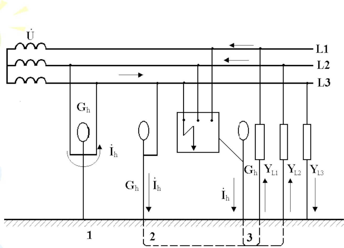
Рис.1. Типовые схемы включения человека в электрическую цепь
