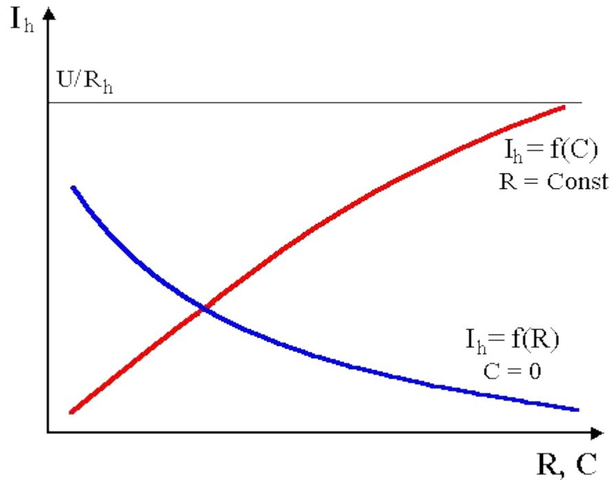
Зависимость значения тока, протекающего через тело человека, прикоснувшегося к фазному проводу в сети с изолированной нейтралью с симметричными параметрами в нормальном режиме работы, от сопротивления изоляции и емкости фазных проводов относительно земли
