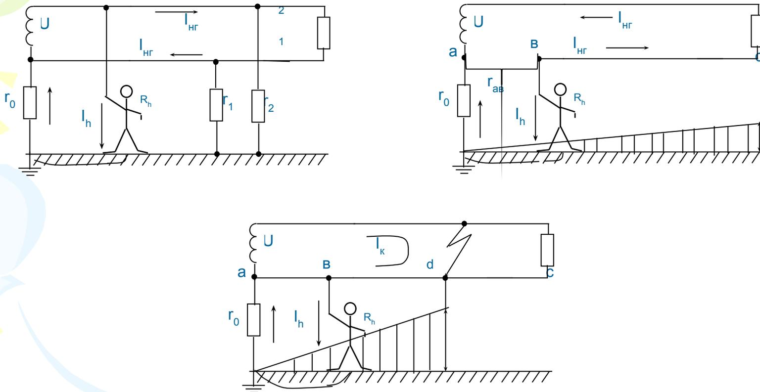
Рис. 4. Прикосновение человека к проводам однофазной двухпроводной сети с заземленным проводом: а - прикосновение к незаземленному проводу; б - прикосновение к заземленному проводу при нормальном режиме сети; в - прикосновение к заземленному проводу при коротком замыкании между проводами
