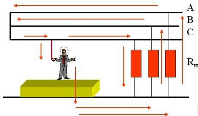
При одинаковом  $R_{и}$  каждой фазы суммарное сопротивление изоляции равно:
