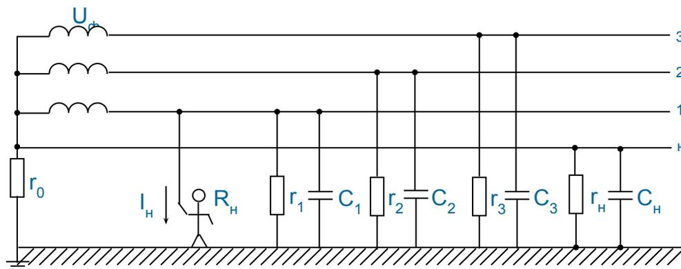
Рис. 2. Прикосновение человека к фазному проводу трехфазной четырехпроводной сети с глухозаземленной нейтралью в нормальном режиме работы:
