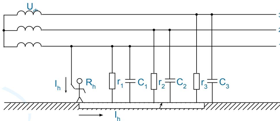
Рис. 5. Прикосновение человека к проводу трехфазной трехпроводной сети с изолированной нейтралью при нормальном режиме работы
