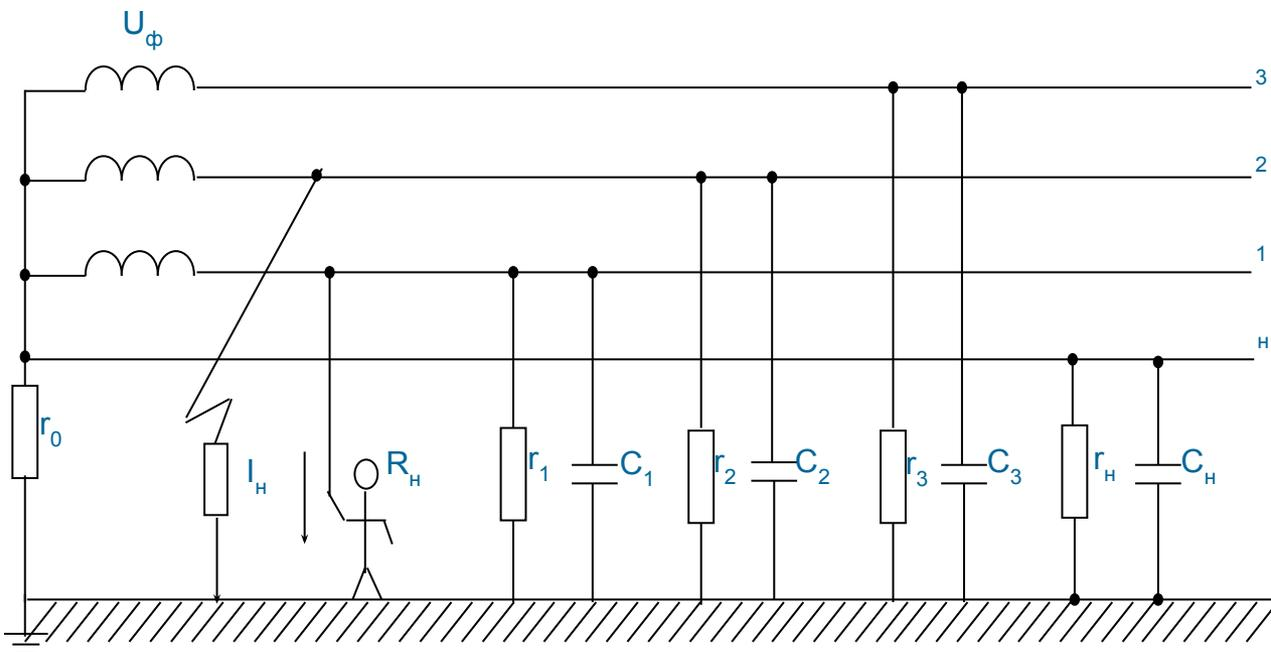
Рис. 3. Прикосновение человека к фазному проводу трехфазной четырехпроводной сети с глухозаземленной нейтралью в аварийном режиме работы:
