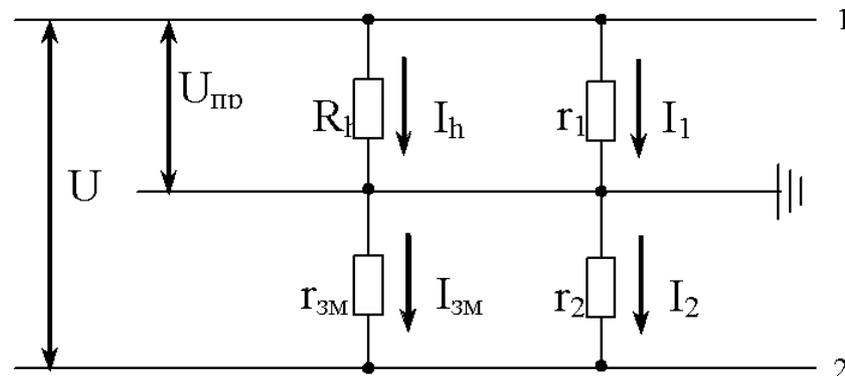
Рис. 3. Прикосновение человека к проводу однофазной двухпроводной сети:
