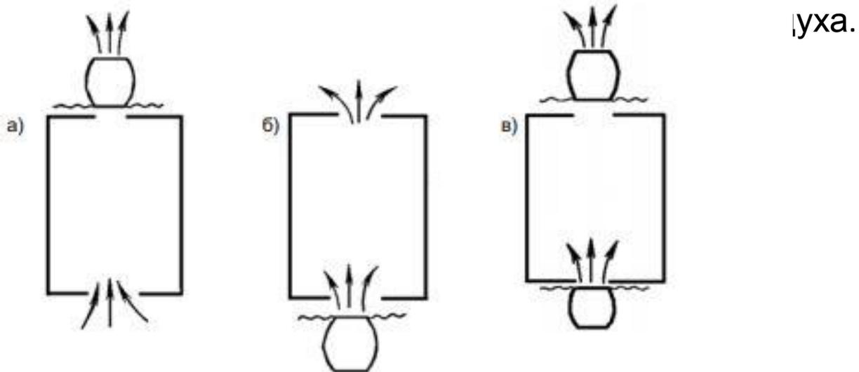
Рис. 9.4. Схемы установки дымососов на пожаре: а — отсос дыма; б — нагнетание свежего воздуха; в — комбинированный способ
