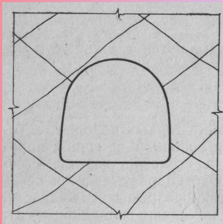
Рис.1 Упорядоченная трещиноватость
